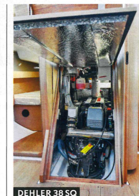
DEHLER 38 SQ Der Saildrive ist vorn eingebaut. Der Motor dahinter ist schlechter erreichbar
