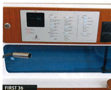
FIRST 36 Tipptopp. Die digitalen Tasten können als Backup auch manuell geschaltet werden
