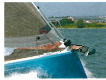
HANSE 315 Smarte Lösung. Die Ankerhalterung dient auch als Bugspriet und ebenso als Tritstufe
