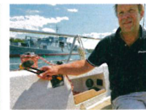
SIRIUS 310 DS Die Winskurbel dient auch als Motorenhebel, ist aber an dieser Stelle sehr exponiert
