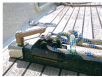
HR 310 Der Traveller auf den Duchten ist effizient und im Hafen für mehr Bequemlichkeit abnehmbar
