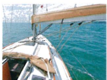
DUFOUR 310 Die Großschot ist vor dem Niedergang angeschlagen. Allerdings gibt es keine Travellerfunktion
