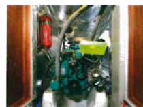
SIRIUS 310 DS Der Motorraum unter dem Decksalon ist weniger gut zugänglich als unter dem Niedergang
