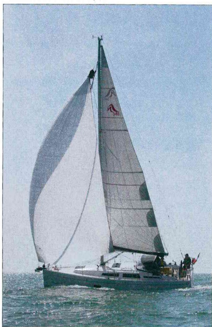
▲ Le gréement avec barres de flèche poussantes avantage bien la puissance donnée à la GV.
