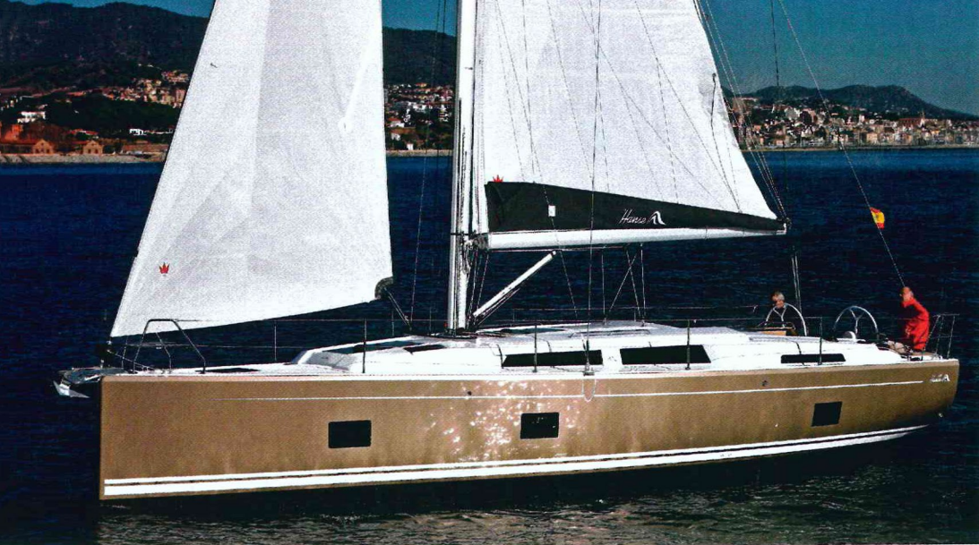
18. El Hanse 418 apareja mayor de sables forzados o enrollable en el palo, foque autovirante y gennaker. Una configuración cada día más popular en embarcaciones de crucero puro.
