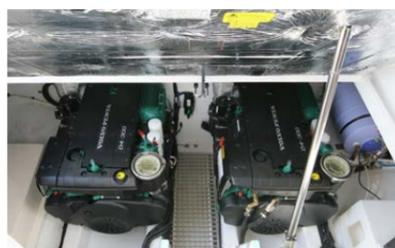
Das Testboot war mit zwei D4-300-EVC-Motoren von Volvo Penta ausgestattet. Die Motorisierung passt gut, auch wenn die C390 insgesamt über 10 Tonnen schwer ist, scheint ein Upgrade auf zwei D6-380 nicht nötig zu sein. Bemerkenswert: Der Motorraum unter der Hecksitzbank kann elektrisch geöffnet werden und bietet Platzverhältnisse, die jeden Mechaniker freuen.
